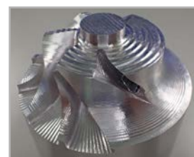
Rotura durante el mecanizado
